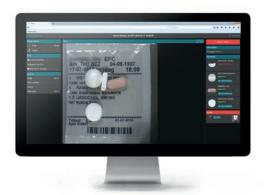
Wenn die Prüfung der Blisterbeutel durch den CONSIS Pouch Inspector abgeschlossen ist, lassen sich die Ergebnisse auf sehr intuitive Weise kontrollieren, validieren und archivieren. Pi Web arbeitet auf der Grundlage einer Aufgabenliste. Validierte Chargen werden auf eine Finalisierungsliste gesetzt und Chargen mit fehlerverdächtigen Beuteln lassen sich unmittelbar korrigieren und validieren.
